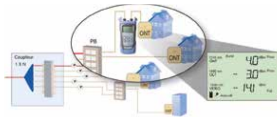
Figure 7.20 : insertion d'un testeur dans l'installation d'abonné
