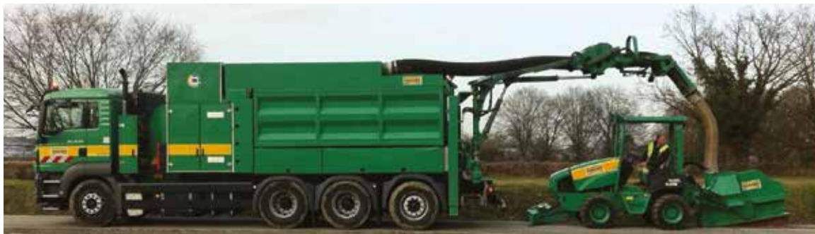
Figure 5.14 : atelier de micro-tranchage en action
