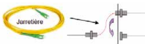
Figure 4.27 : principe de brassage d'une jarretière 1,6 ou 2mm
