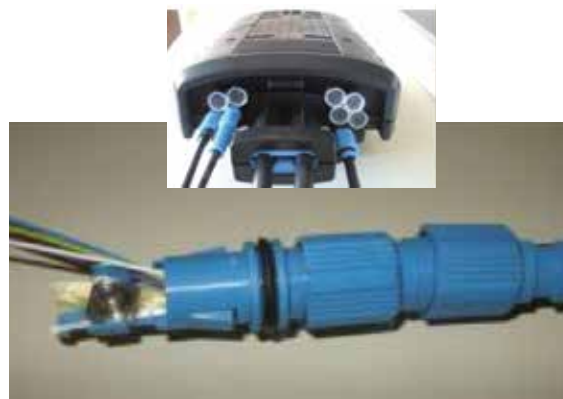
Figure 4.45: entrées et sorties de câbles
