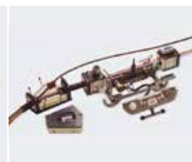
Figure 5.16 : pose en conduite occupée avec un câble
