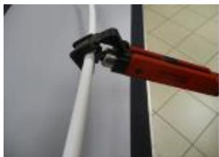
6. A l'aide de l'outil ACOME IB3000 refendre le câble sur la longueur préparée. Réglage des lames : 1,2 mm (jauge fournie avec l'outil). Cales de guidage référence 9.
