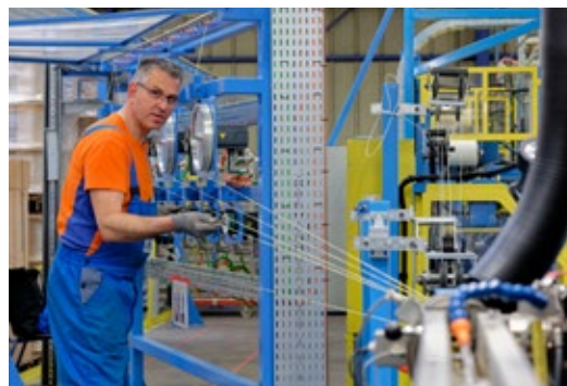
Fertigungswerkstatt für „Drop“-Kabel für den Glasfaseranschluss beim Endkunden (2019)
